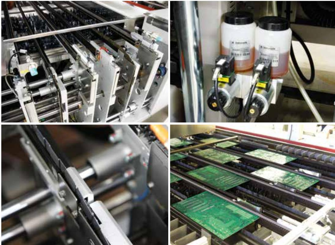
oben links: Doppelspur-Transport, oben rechts: Kettenöler
