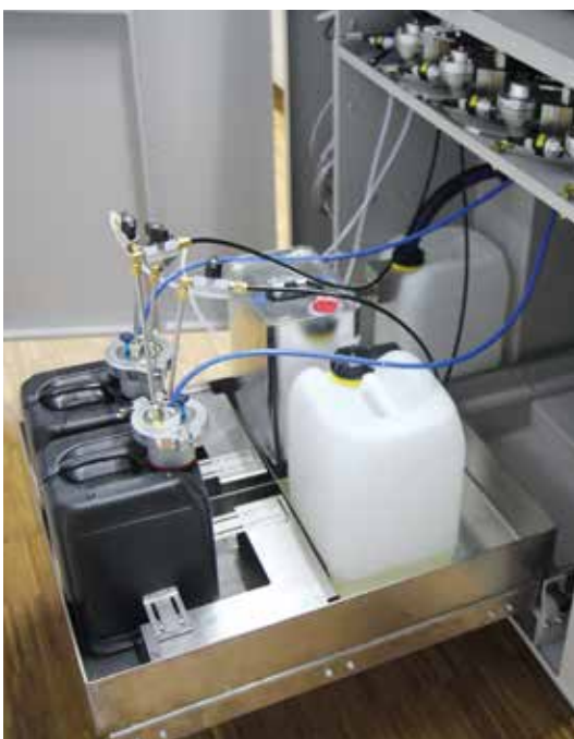
Leicht zugängliche Lackbevorratung in der Anlage
