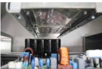
Leistungsstarke Strahler im RDS 1200 UV für die Trocknung aller UV-aushärtenden Lacke
