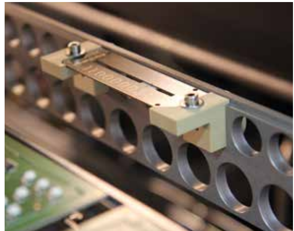
Warenträger mit Temperatursensor in Beladeposition
