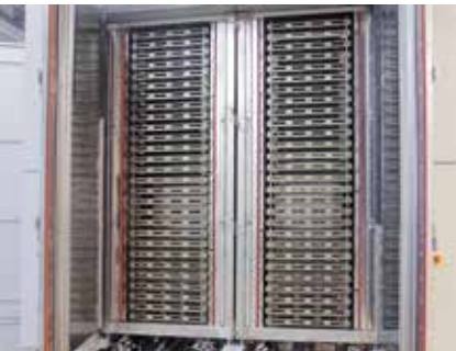
Vertikales Stapelprinzip in den Prozesstürmen zur Aufnahme der Warenträger
