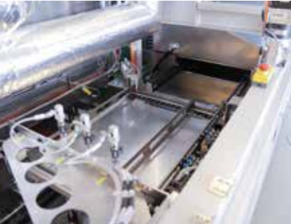
Warenträger mit flexibler Breitereinstellung zur Aufnahme von Leiterplatten mit unterschiedlicher Transportbreite
