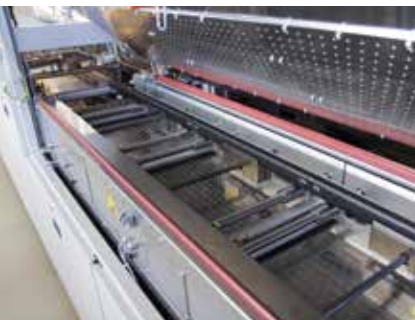
Segmentierte Kühlstrecke mit automatischer Breitenverstellung pro Zone für die Verarbeitung unterschiedlicher Leiterplattengrößen
