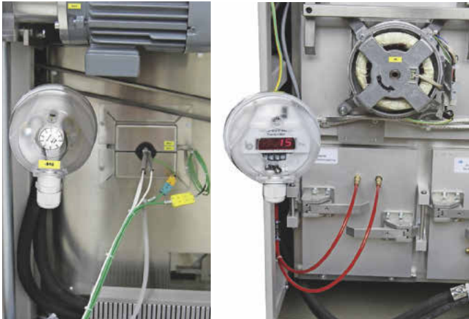
Zustandsüberwachung der Pyrolyse (links) und der Kaltkondensationskühlstrecke (rechts).
