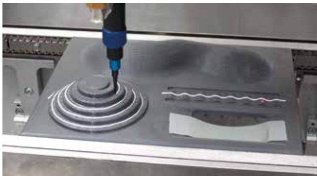
Präziser Materialauftrag bei komplexen Geometrien
