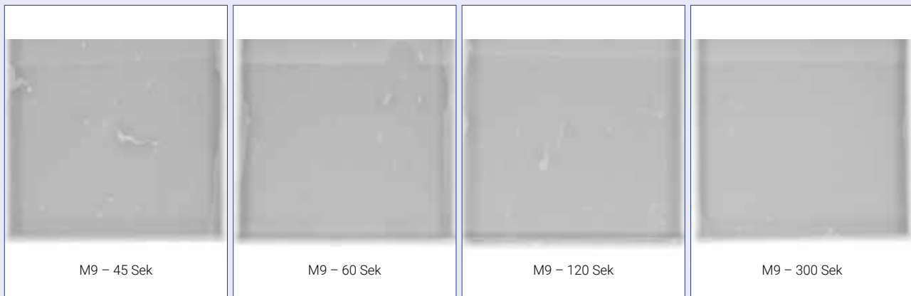
Abbildung 5 a – d: Röntgendurchstrahlungsbilder der Dummy-Lötstellen für Aktivierungszeiten von 45 bis 300 Sekunden.
