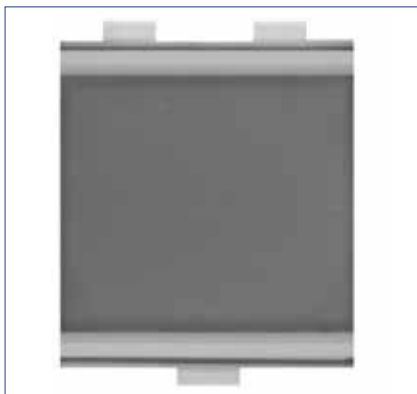
Abbildung 6: Röntgendurchstrahlungsbild eines IGBT auf Kühlplatte nach dem Lötprozess mit 60 Sekunden Aktivierungszeit und 300 µm Preformdicke.
