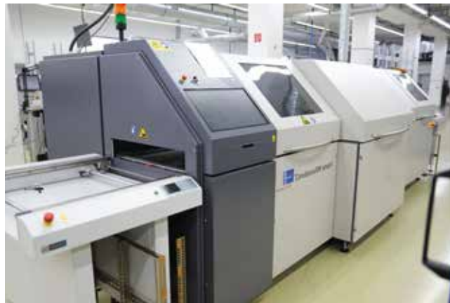
Auch beim Dampfphasenlötens setzt Hannusch auf die Systeme von Rehm, hier die inlinefähige CondensoxM smart.
