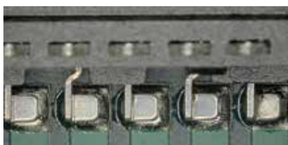
Entstehung und Vermeidung der Wicking-Defekte beim Lötén von Steckverbindern
