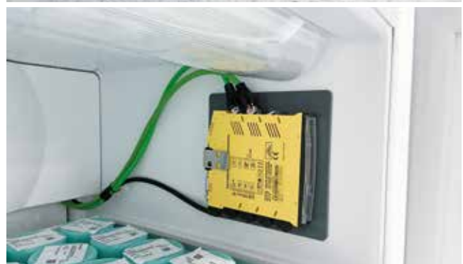
Kühlschränke zur Pastenlagerung (oben), IM18-CCM erfasst und analysiert Zustandsdaten (unten)
