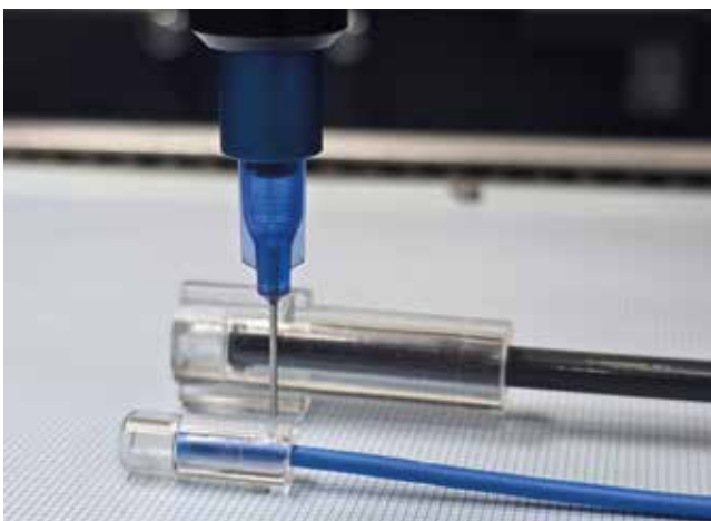
Hochgenauer Auftrag von Klebstoff auf ein Kathetersystem durch die Rehm ProtectoXP
