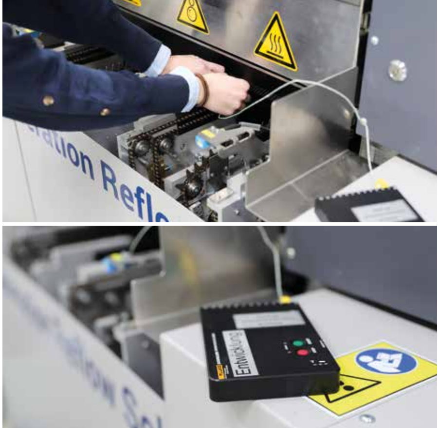
Mit einem Temperatur-Datenlogger können die Temperaturen verschiedener Anwendungen in Echtzeit überwacht werden.
