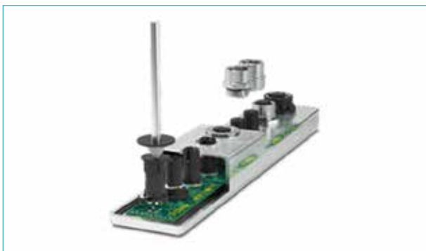
Abbildung 5: Vereinfachte Bestückung mittels Pick&Place-Pad in einer beispielhaften Produktumsetzung.
