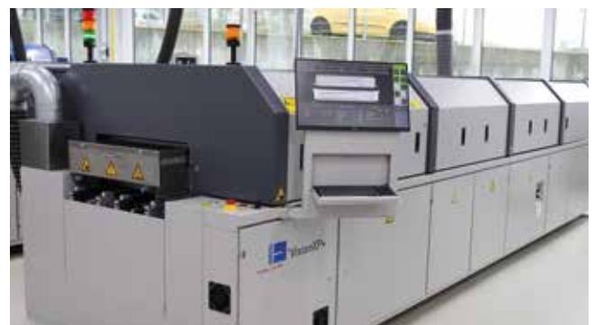
Patentierter mechatronischer Vorhang, Absaugung am Einlauf, ergonomischer Bildschirm – ressourcenschonendes Redesign
