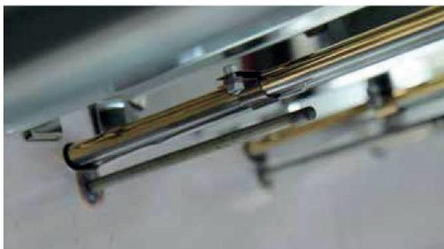
Damit die Bauteile optimal ausgehärtet werden können, verfügen die Trockner über eine Innentemperaturüberwachung. In jeder Heizzone sind Thermoelemente montiert, welche die Temperatur in der Anlage präzise messen. Die Werte werden auf dem Monitor dargestellt. Sobald die Toleranzwerte überschritten sind, wird ein akustischer Alarm ausgelöst und die Heizung abgeschaltet.
