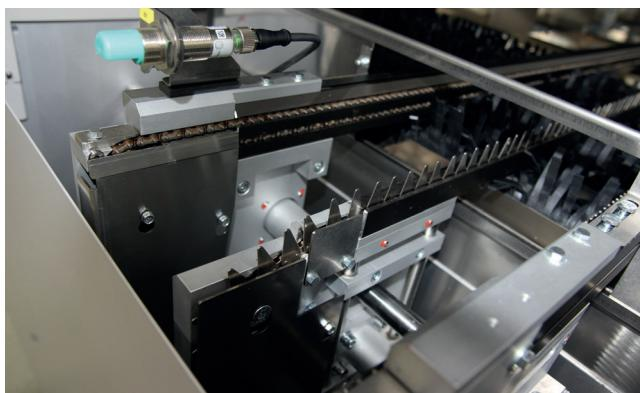
Bei kurzen Prozesszeiten kann auch ein reines Inline-Verfahren zum Einsatz kommen. Hier kann äquivalent zur Halterung der Proben im System eine Stiftkette die Randauflage für die Produkte im Ofen sein. Der Vorteil ist, dass sowohl von oben als auch von unten ungehindert Wärme eingetragen werden kann. Mit Stiftkettentransport lässt sich auch die Transportbreite variabel verstellen, so dass das System auf unterschiedliche Produktbreiten angepasst werden kann.
