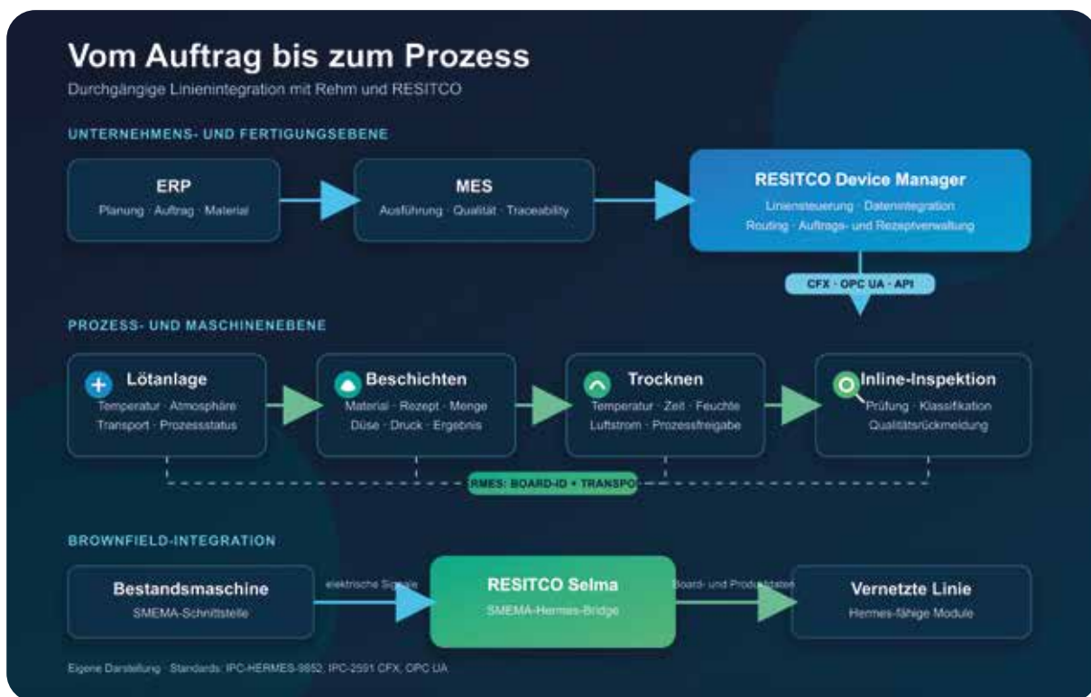
Grafik 2: Der Device Manager verbindet Auftragssteuerung, Prozessanlagen und Traceability.
