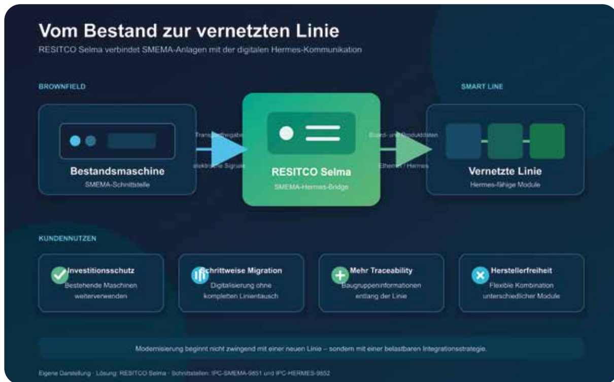
Grafik 3: Selma bildet die Brücke zwischen einer bestehenden SMEMA-Maschine und der digitalen Hermes-Linie.
