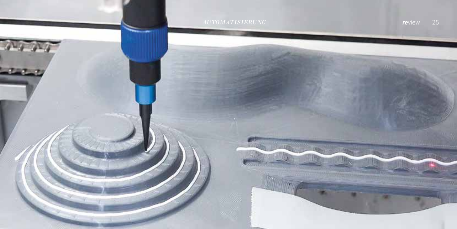
Abb. 4: Präziser Materialauftrag bei komplexen Geometrien mit integriertem 3D-Höhensensor (Bildquelle: Rehm)
