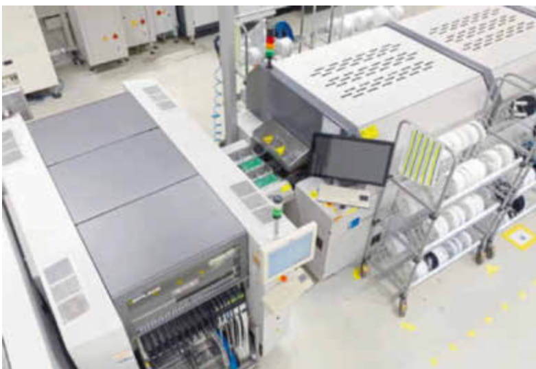
Die Reflow-Lötanlage VisionXP+ hat als neue Features einen mechatronischen Vorhang und eine verbesserte Isolierung.
