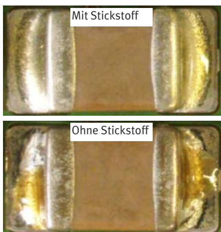
Abbildung 5: Vergleich der Lötstellen mit und ohne Stickstoff (links) und mit und ohne Vakuum (rechts).
