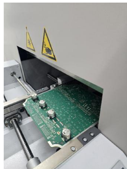
Abbildung 3: Hurricane Applikator (links) und Trocknung einer Baugruppe im UV-LED-Trockner (rechts).
