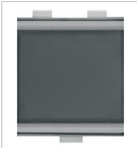
Bild 6: Röntgendurchstrahlbild eines IGBT auf Kühlplatte nach dem Lötprozess mit 60 Sekunden Aktivierungszeit und 300 µm Preformdicke.
