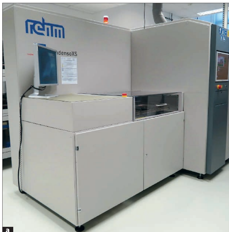
Bild 1 a - c: Lötprozesse mit Ameisensäure von Rehm Thermal Systems
